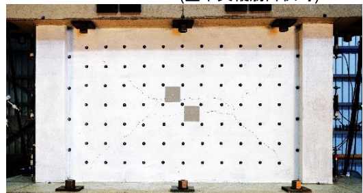
写真-4 WOI試験体面外載荷後
